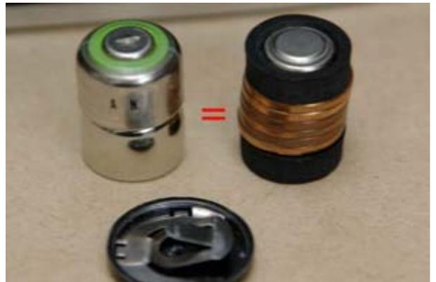
Note: insérer dans l'ordre la première pile avec sa rondelle, les 6 eurocents et la deuxième pile avec sa rondelle
