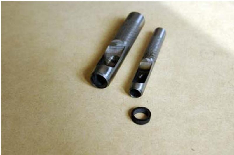
Réaliser une rondelle de 16 mm de diamètre à l'emporte-pièce;
