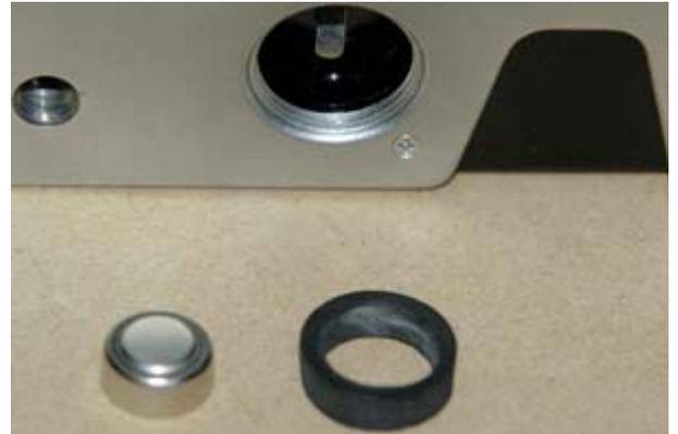
Note: cintrer légèrement la languette de contact au fond du logement pour récupérer les 6/10e de mm de différence d'épaisseur
