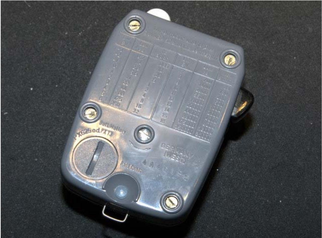
Dévisser les 4 vis et ouvrir le boîtier par l'arrière ne présente alors aucune difficulté.
